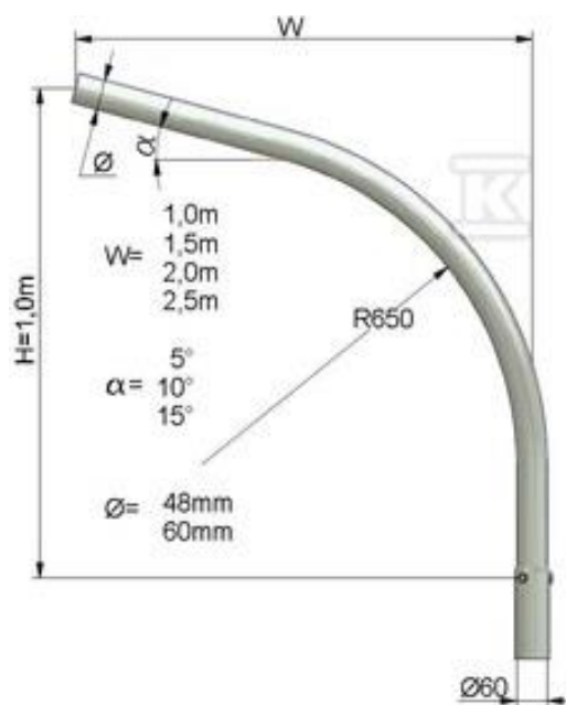
Wysięgnik NT ST-Y/1r/W= / α= / Ø=
